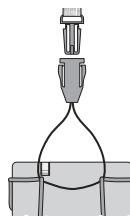
Tire del lazo de la cinta por la pinza, deslice el pulsador de la cinta para ajustar su longitud y pase la cinta por su cuello. Abriendo el cierre ( figura de la izquierda), el aparato se puede quitar fácilmente e intercambiar por otro.
