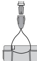
tirez la boucle de fixation de la courroie via l'étrier ; en déplaçant le bouton sur la bandoulière, réglez la longueur voulue puis passez la bandoulière autour du cou. En déverrouillant le système de fixation, (voir schéma gauche), vous pouvez retirer facilement l'appareil et le remplacer par un autre.
